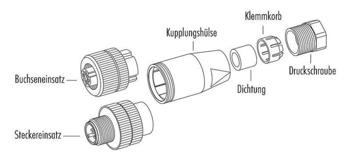
Material der Gewinderinge: Kunststoff, Zink Druckguss, Edelstahl
